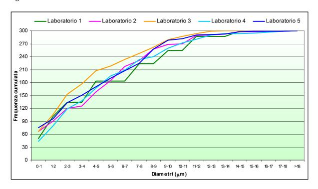
Figura 4 - Comminuzione con bisturi: lettura 300 diametri con tecnica SEM
