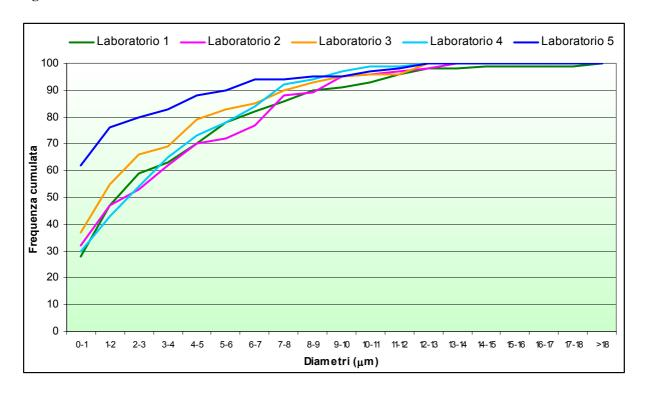
Figura 3 - Comminuzione con bisturi: lettura 300 diametri con tecnica MOCF
