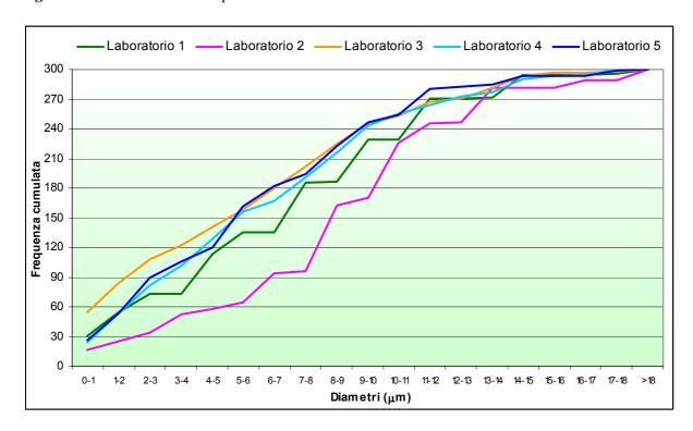
Figura 8 - Comminuzione con pressa: lettura 300 diametri con tecnica SEM
