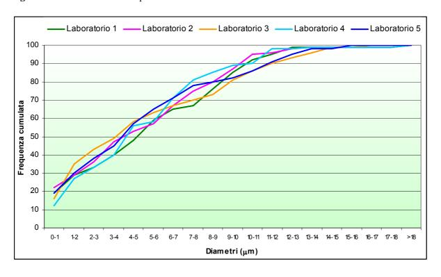
Figura 7 - Comminuzione con pressa: lettura 300 diametri con tecnica MOCF
