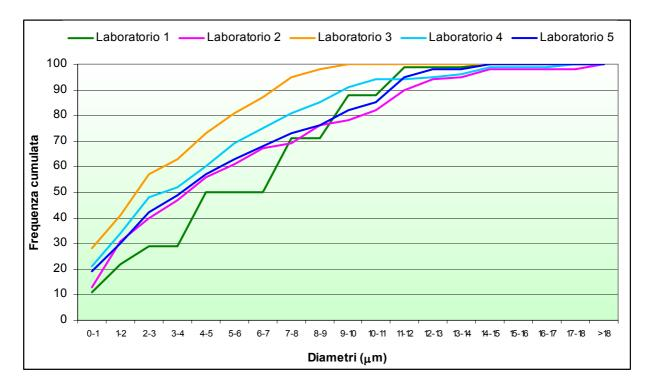
Figura 2 - Comminuzione con bisturi: lettura 100 diametri con tecnica SEM
